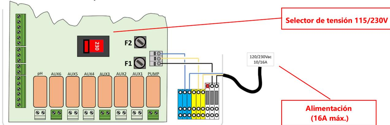
Figura 5 - Conexión eléctrica y selector de tensión.
