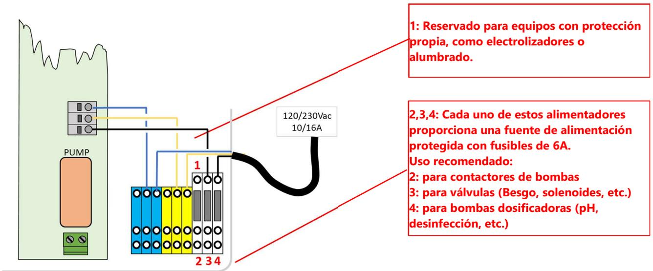
Figura 7 – Utilización de bloques de distribución de energía
