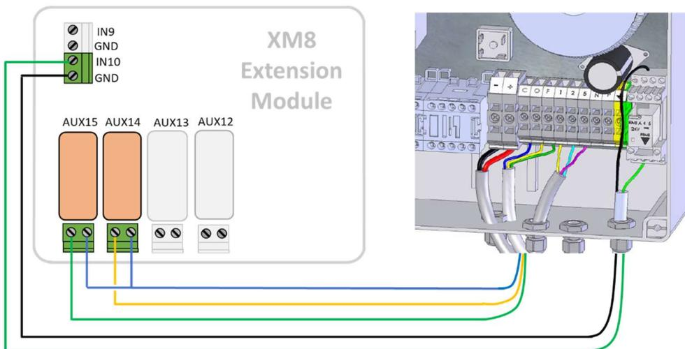
Figura 70 - Ejemplo de conexión con la cubierta Astral Roussillon
