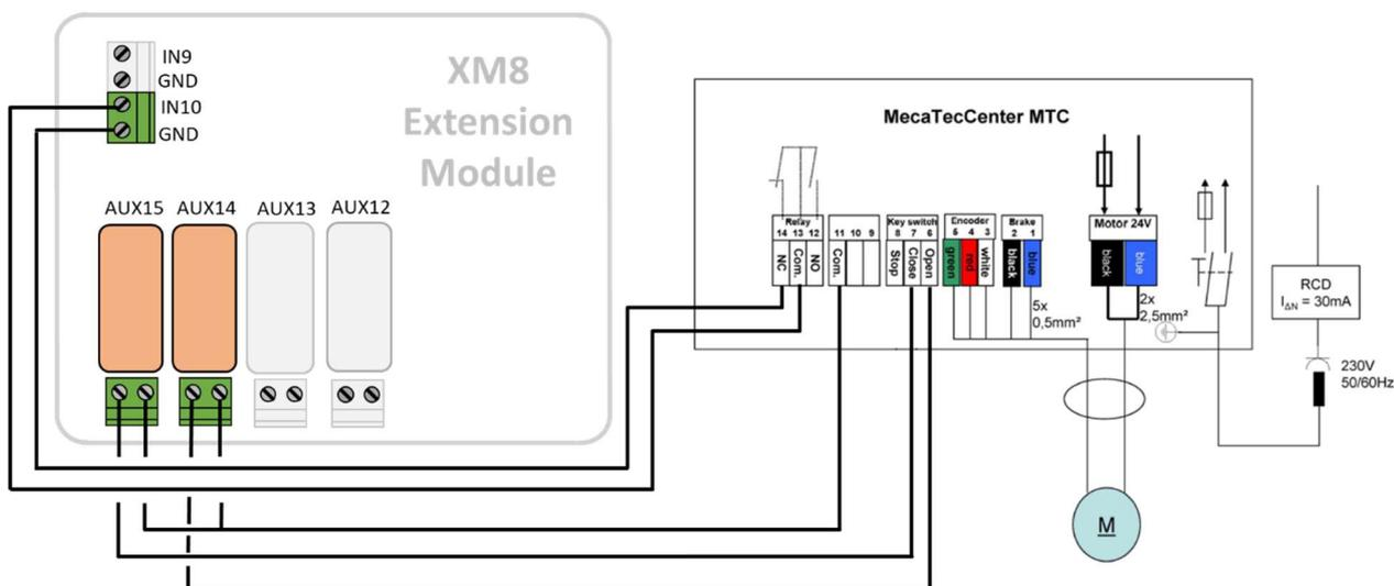
Figura 69 - Ejemplo de conexión con la cubierta de MecaTecCenter
