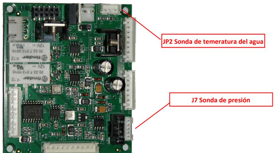
**Figura 32 - Conexión de sondas de presión y temperatura del agua**
