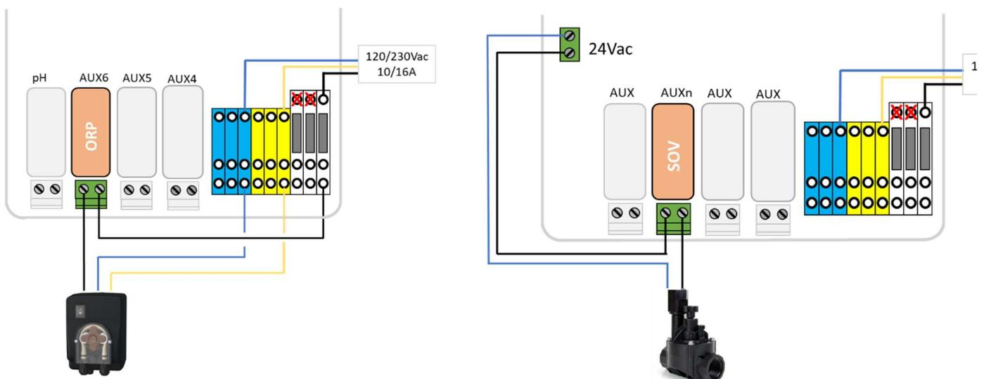
**Figura 54 - Conexión de bomba dosificadora de 230 V CA o electroválvula de 24 V CA para desinfección**
