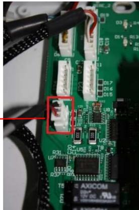
Figure 33 - Sonda de temperatura de aire
