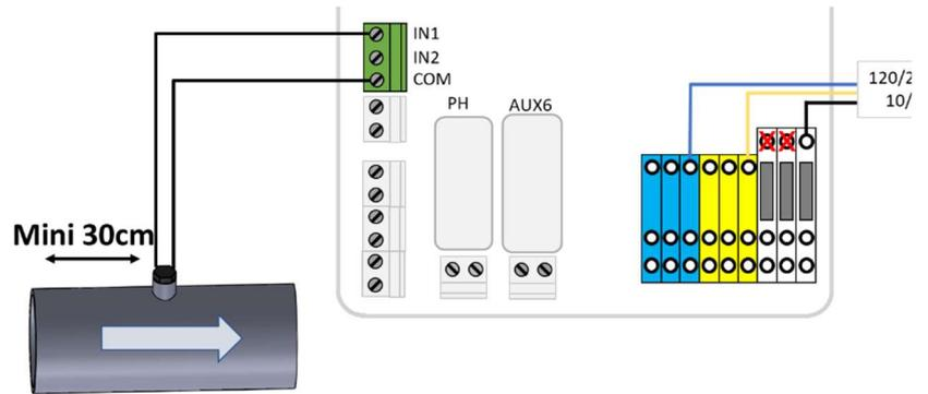
**Figura 76 - Conexión del interruptor de flujo a una entrada**
