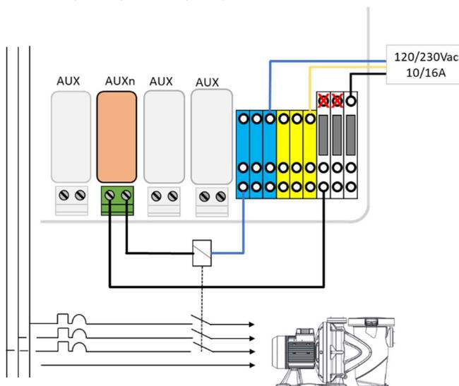
**Figura 38 - Conexiones auxiliares trifásicas**
