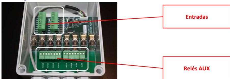
**Figura 61 - Bloques de terminales**
