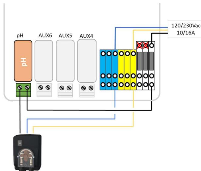
Figura 53 – Conexión directa de la bomba dosificadora de pH 230Vac.
