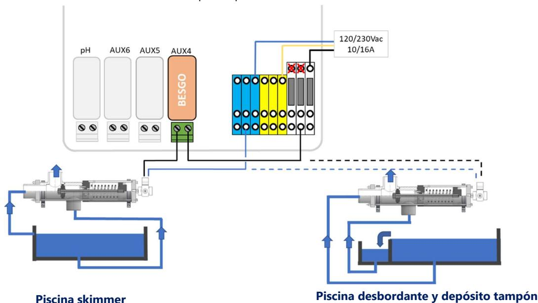
**Figura 64 - Conexión de una válvula de enjuagar de 3 vías BESGO en 230Vac**
