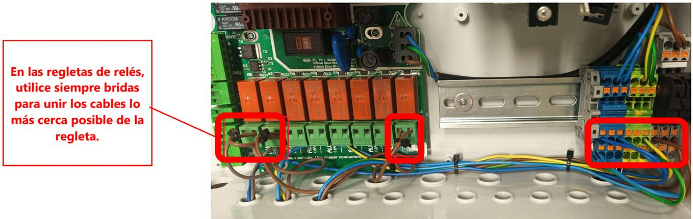
Figura 8 - Conexión de la salida de relé
