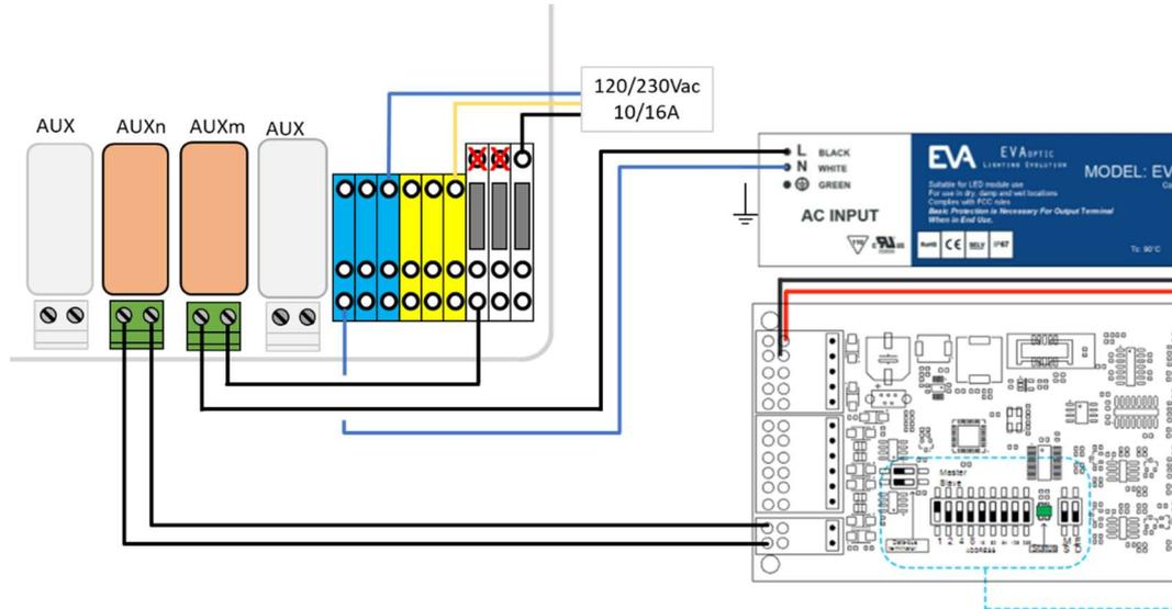
Figura 81 - Conexión luz Eva Optic
