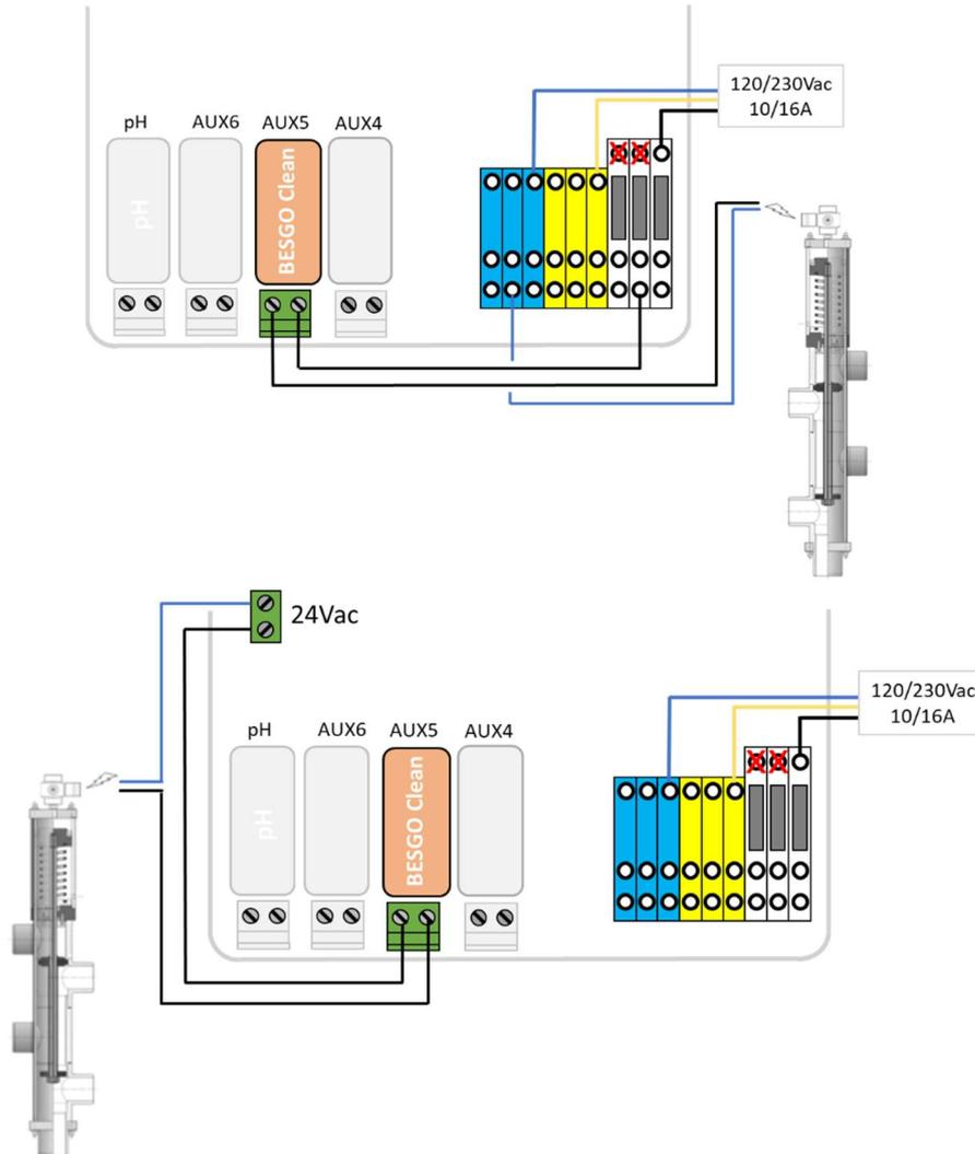
Figura 62 - Conectando BESGO en 230VAC o en 24VAC
