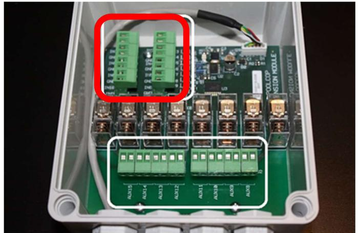
Figura 40 – Conexión de las Entradas en el XM8
