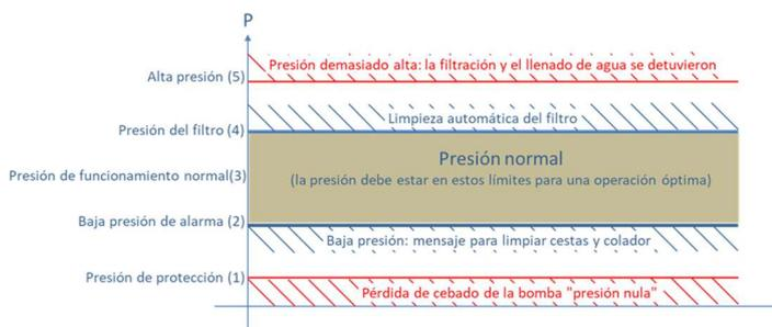
Figura 83 - Parámetros de ajuste de presión.
