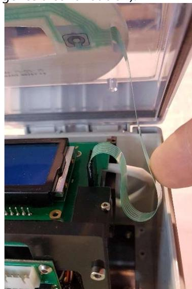
Figura 35 - Guiado del cable del teclado
