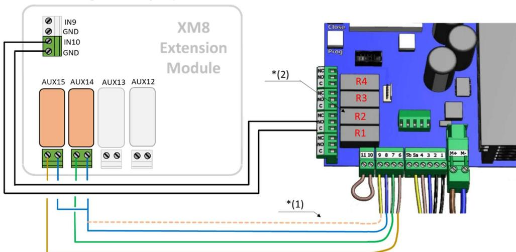
Figura 71 --Ejemplo de conexión con la cubierta SWIMSAFE
