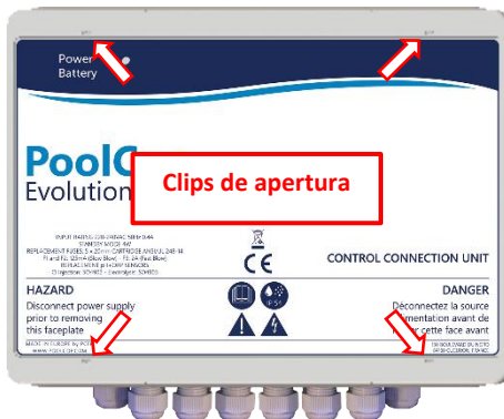
Figura 4 - Apertura de la caja
