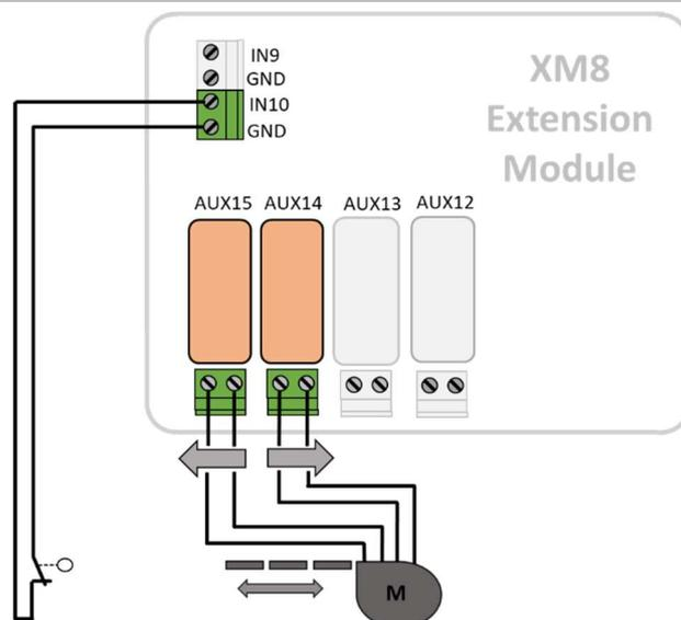
Figura 68 - Conexión de la cubierta de la piscina (control y posición)
