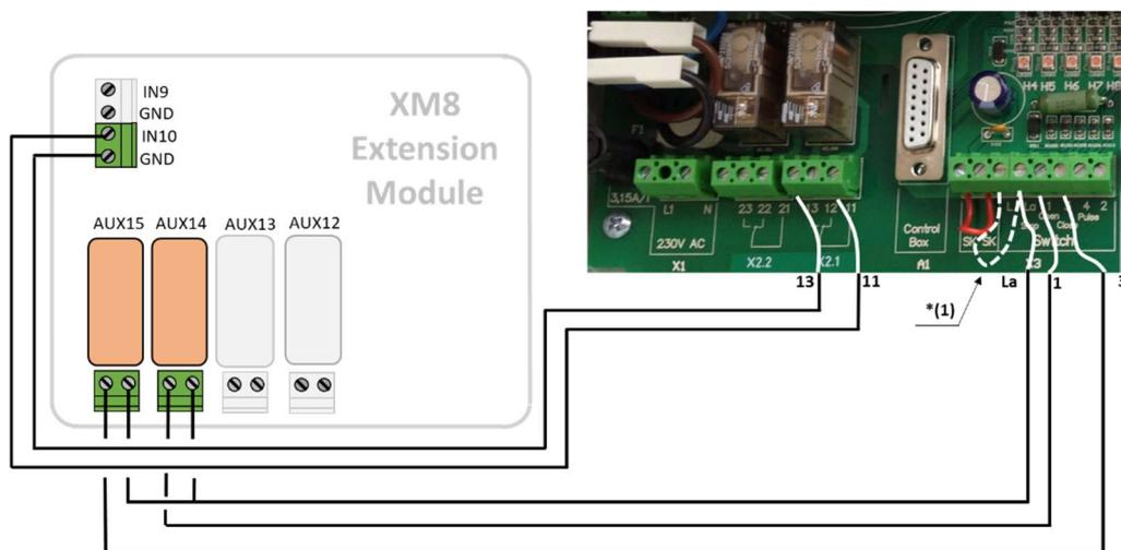
Figura 72 - Ejemplo de conexión con la cubierta Aqua Dec
