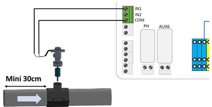
Figura 80 - Conexión del interruptor de flujo a la entrada (1)
