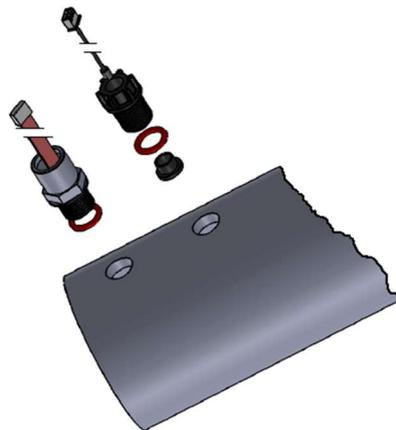
**Figura 29 - Sensores atornillados a tubería de 3 "**
