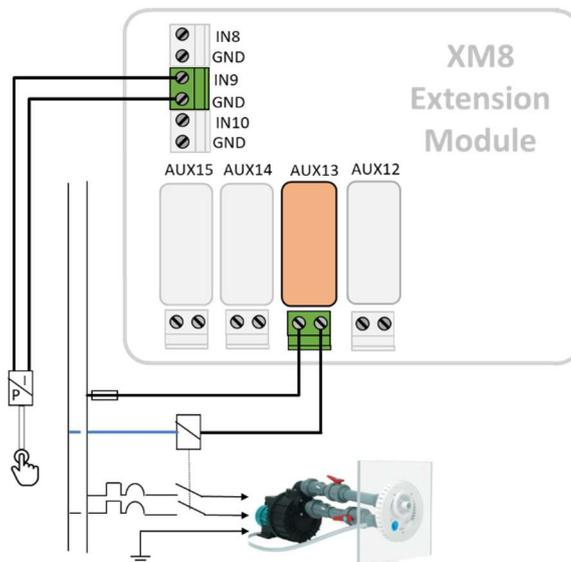
Figura 73 - Conexión de una jetstream
