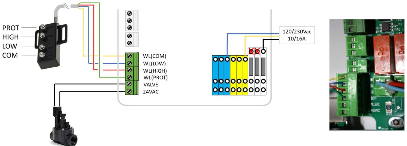
Figura 58 - Conexión del sensor de nivel de agua
