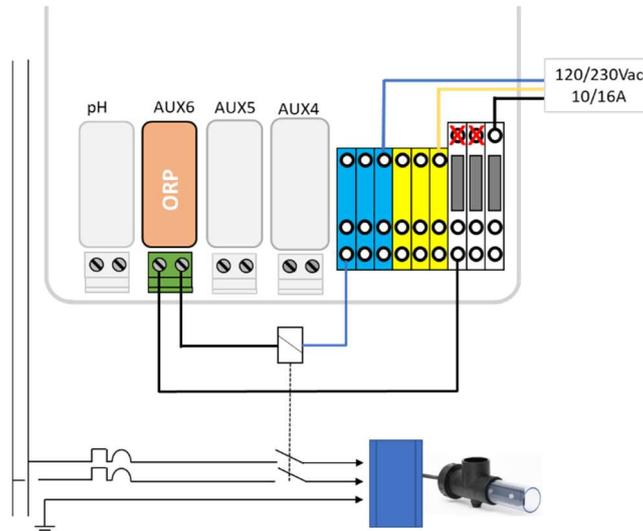
Figura 55 - Conexión del electrolizador de sal
