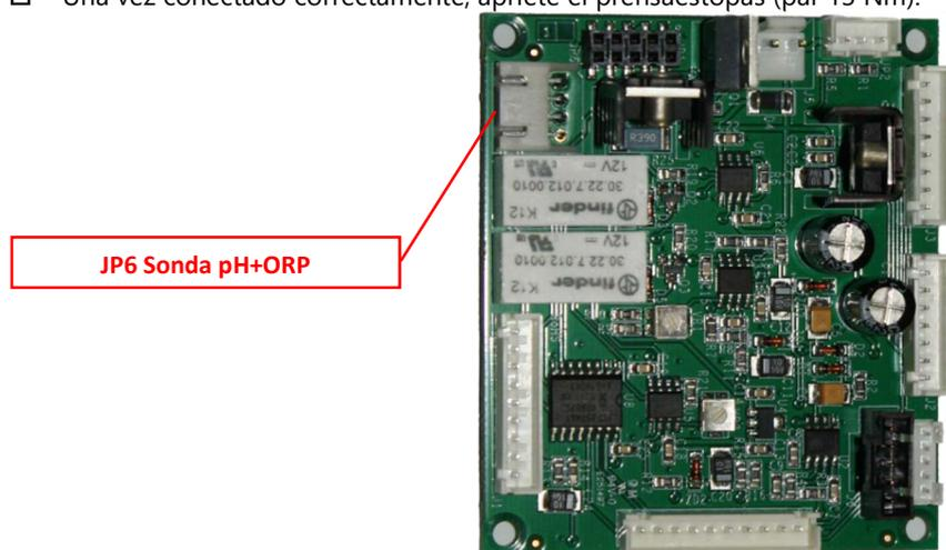
Figura 52 - Conexión de la sonda pH + ORP
