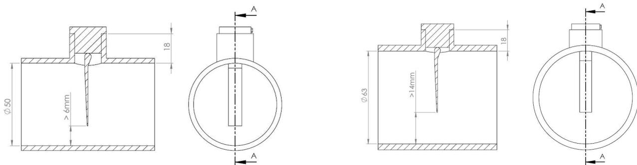
**Figura 77 - Ajuste de la longitud de la paleta**
