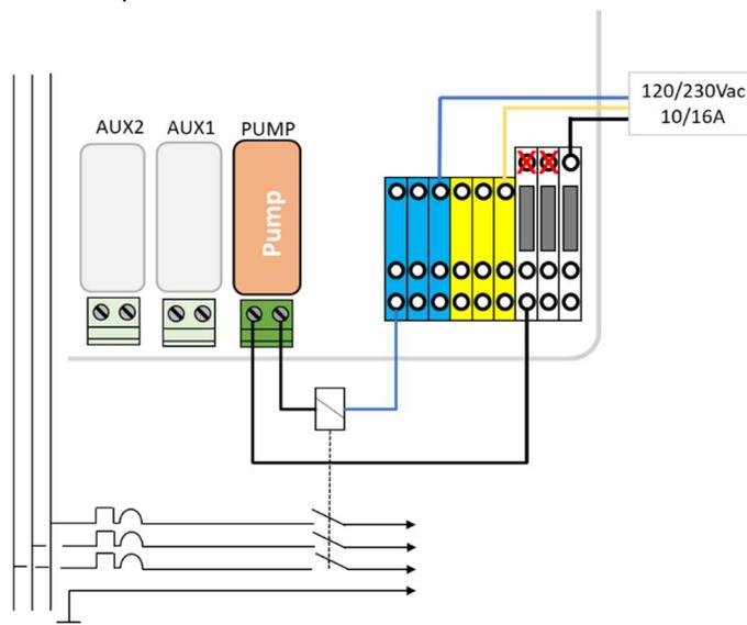
Figura 10 - Conexiones bomba trifásica
