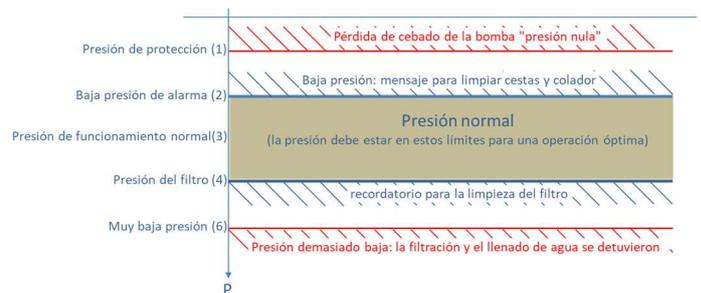
Figura 84 - Parámetros de ajuste de succión.
