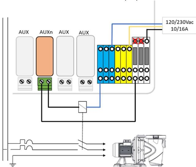
**Figura 37 - Conexiones auxiliares monofásicas**
