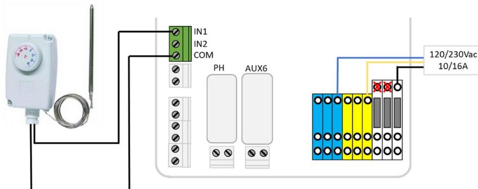
**Figura 42 - Conexiones Termostato Externo**
