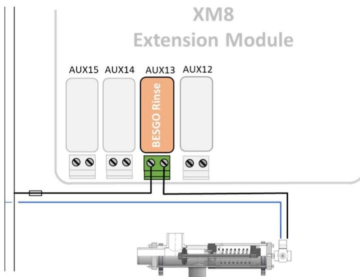
Figura 63 - Conexión de una válvula de enjuagar de 3 vías BESGO en 230Vac
