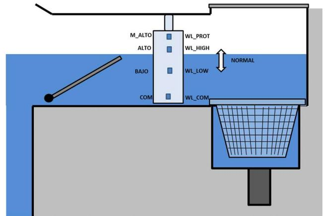
Figura 56 - Sensor de nivel línea de agua
