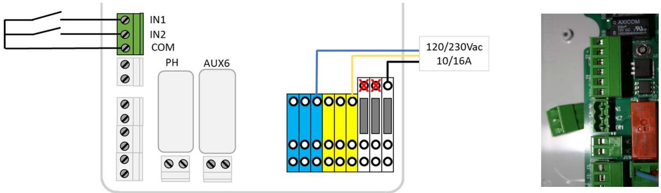
Figura 39 – Conexión de las Entradas en el DCCU
